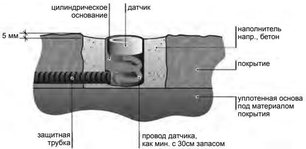
Пример монтажа датчика температуры и влажности в поверхности
