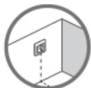
**Примечание.** Датчик температуры пола обеспечивает более точный контроль температуры. Он рекомендуется для применения со всеми системами подогрева пола и **обязателен** к применению с деревянными покрытиями пола для снижения риска их перегрева.
